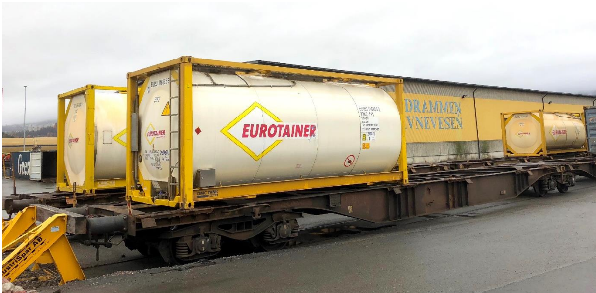
Yara tank-containerer lastet på jernbane på Holmen.
