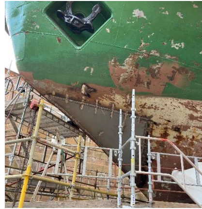
Bytte av stål i baugen
